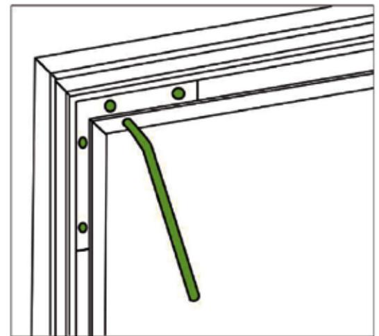
Terminer le montage d'un côté du cadre en fixant les 2 équerres.
